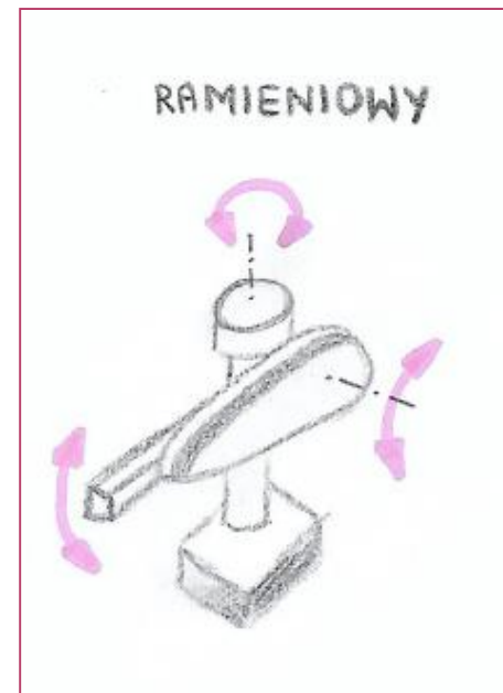
Rys3. Robot ramieniowy Źródło: Szkic ręczny ołówkiem własnego autorstwa
