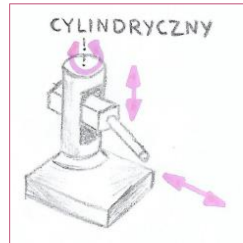
Rys2. Robot cylindryczny Źródło: Szkic ręczny ołówkiem własnego autorstwa
