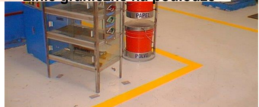
Linie graniczne na podłodze
